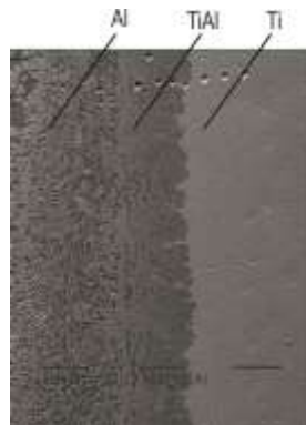
Рис. 1. Мікроструктура з'єднання титану ВТ1-0 із технічним алюмінієм АД1, що містить у своєму складі шар інтерметаліду TiAl ( \times 400 )
